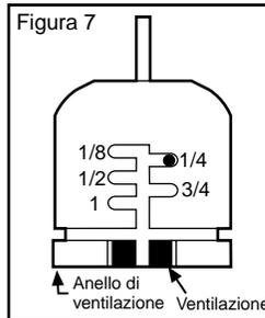
Il Mini-Clik può prevenire l'avvio oppure interrompere il funzionamento dell'impianto di irrigazione dopo cadute di pioggia di 1/8" (0,32 cm), 1/4" (0,64 cm), 1/2" (1,27 cm), 3/4" (1,90 cm) o 1" (2,54 cm). Per regolare il livello di pioggia per l'innesto, ruotare il cappuccio sulla scatola del ruttore in modo che le copiglie siano situate nelle opportune tacche (vedere Figura 7). Non forzare mai il cappuccio perché si rischia di rompere le copiglie.
