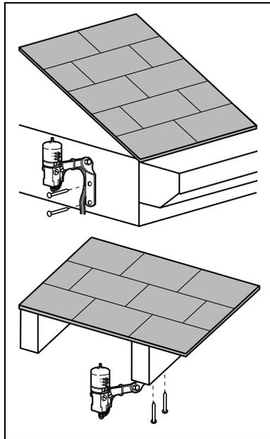
**Für das Leitungsmodell Mini-Clik-C:** Die Leitung ist für die Einheit wie ein Stützträger. Platzieren und befestigen Sie demnach die Leitung so, dass für den, wie in den Hauptanweisungen für das Standardmodell beschriebene, gewünschte Melderort, gesorgt werden kann. Sorgen Sie außerdem für eine ausreichende Stützung der Leitung entlang ihrer verschiedenen Längenabmessungen.
