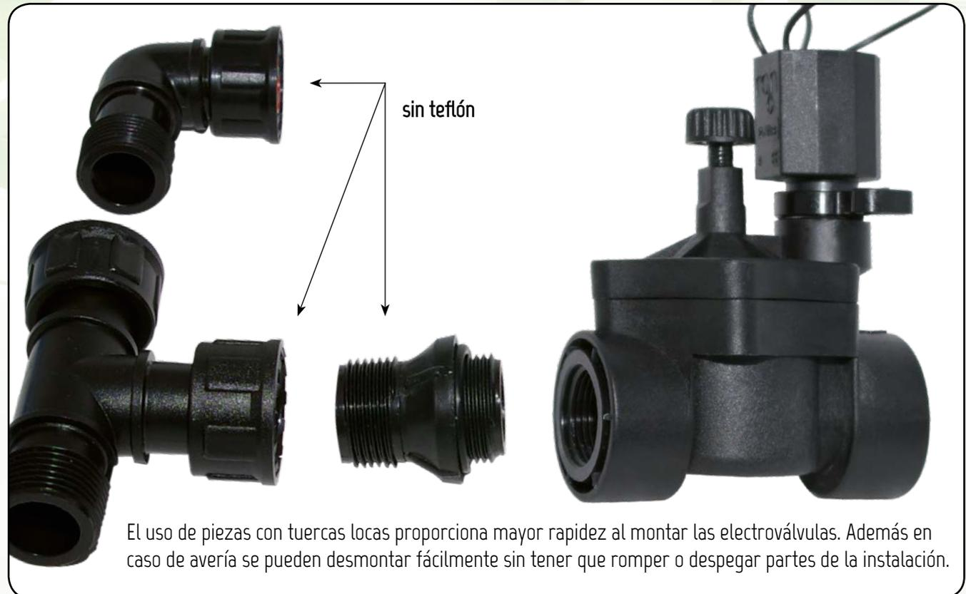
El uso de piezas con tuercas locas proporciona mayor rapidez al montar las electroválvulas. Además en caso de avería se pueden desmontar fácilmente sin tener que romper o despegar partes de la instalación.
