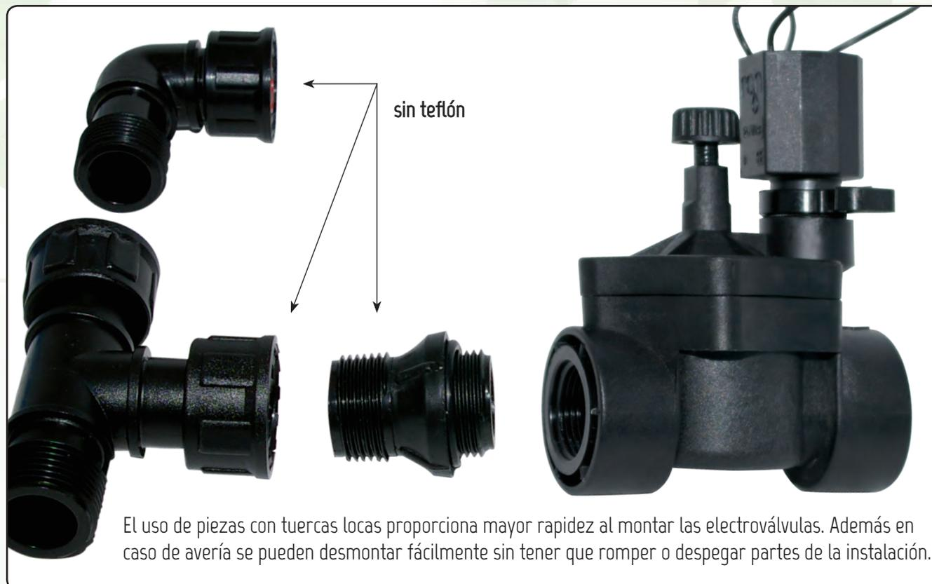
El uso de piezas con tuercas locas proporciona mayor rapidez al montar las electroválvulas. Además en caso de avería se pueden desmontar fácilmente sin tener que romper o despegar partes de la instalación.
