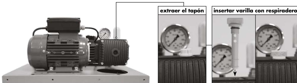
**1** Abra el paso del agua para que esta llegue al equipo. Revise que no hay fugas.
