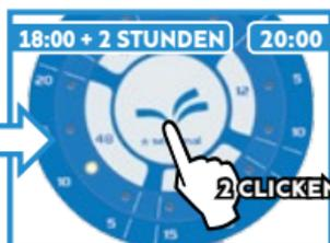
Der Programmierer schaltet sich um 20:00 Uhr 10 Minuten lang ein und wird dies alle 24 Stunden weiterhin tun.
