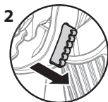
Gatillo desbloqueado (la pistola sí pulveriza)
