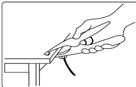
**⚠ ATENCIÓN:** NO PUNTEAR el electrodo sobre la pieza; podría dañarse el revestimiento, haciendo más difícil la atracción del arco. Una vez conseguido el arco, intentar mantener una distancia de la pieza, equivalente al diámetro del electrodo utilizado y mantener esta distancia lo más constante posible, durante la ejecución de la soldadura recordando así mismo, que la inclinación del electrodo, en sentido de avance, deberá ser de entre de 20 o 30 grados.
