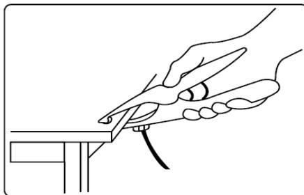
**ATENÇÃO:** NÃO PONTEAR o eléctrodo sobre a peça; poderia danar-se o revestimento, fazendo mais difícil a atração do arco. Uma vez conseguido o arco, tentar manter uma distância da peça, equivalente ao diâmetro do eléctrodo utilizado e manter esta distância o mais constante possível, durante a execução da solda recordando assim mesmo, que a inclinação do eléctrodo, em sentido de avance, deverá ser de perto de 20 ou 30 grados.
