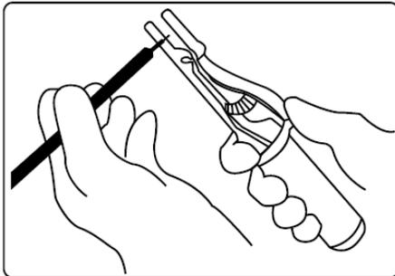
Fixez l'extrémité sans revêtement de l'électrode dans le porte-électrode et connectez la pince de masse à la pièce à souder en veillant toujours à un bon contact électrique. Couvrez-vous les yeux et le visage avec l'écran de protection et essayez de frotter l'extrémité de l'électrode sur la pièce à souder, en suivant un mouvement similaire à l'allumage d'une allumette ; Il s'agit de la méthode la plus indiquée pour provoquer l'arc.
