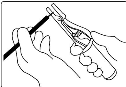
Fijar el extremo no revestido del electrodo en el portaelectrodo y conectar la pinza de masa a la pieza a soldar, procurando siempre un buen contacto eléctrico. Cúbrase los ojos y cara con la pantalla de protección e intente rozar la punta del electrodo sobre la pieza a soldar, siguiendo un movimiento como si se fuese a encender una cerilla; este es el método más correcto para provocar el arco.
