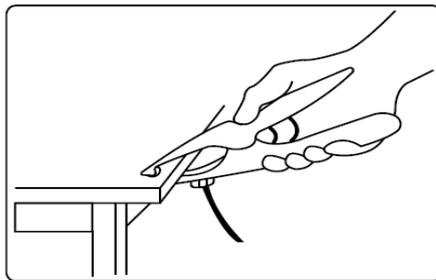
**ATTENTION** : NE PAS APPUYER l'électrode sur la pièce ; le revêtement pourrait être endommagé, ce qui rendrait plus difficile l'attraction de l'arc. Une fois l'arc obtenu, essayez de maintenir une distance par rapport à la pièce équivalente au diamètre de l'électrode utilisée et maintenez-la aussi constante que possible pendant le soudage, en vous rappelant que l'inclinaison de l'électrode, vers l'avant, doit être comprise entre 20 et 30 degrés.
