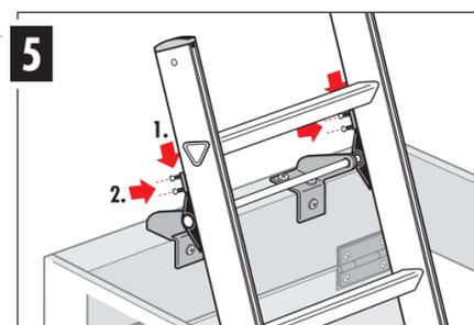
Veiller à ce que l'échelle soit dans la bonne position pour monter, c'est-à-dire glisser les deux butées en plastique noir vers le bas jusqu'à atteindre l'extrémité supérieure du guide d'assemblage.
