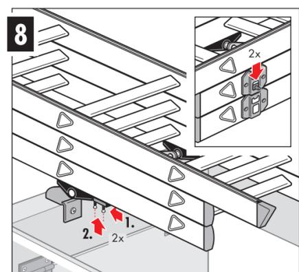
Les plans doivent être repliés ensemble, en s'assurant que les loquets de sécurité sont engagés (position bloquée).
