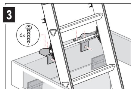
Le guide d'assemblage de l'échelle de grenier doit être monté sur le cadre à l'aide des 6 vis fournies.
