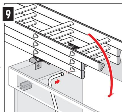
Utiliser l'extrémité de la main courante pour descendre ou monter l'échelle de grenier en l'insérant dans un trou d'échelon.
