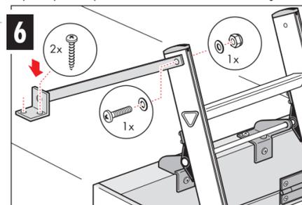
Fixer le bras pivotant sur l'échelle en position déployée et sur le sol du grenier avec la visserie fournie
