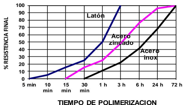
La temperatura ambiental afecta a la velocidad de reacción. La temperatura ideal de polimerización está comprendida entre 20°C y 25°C. Temperaturas comprendidas entre 5°C y 20°C ralentizan la reacción, temperaturas superiores la aceleran.
