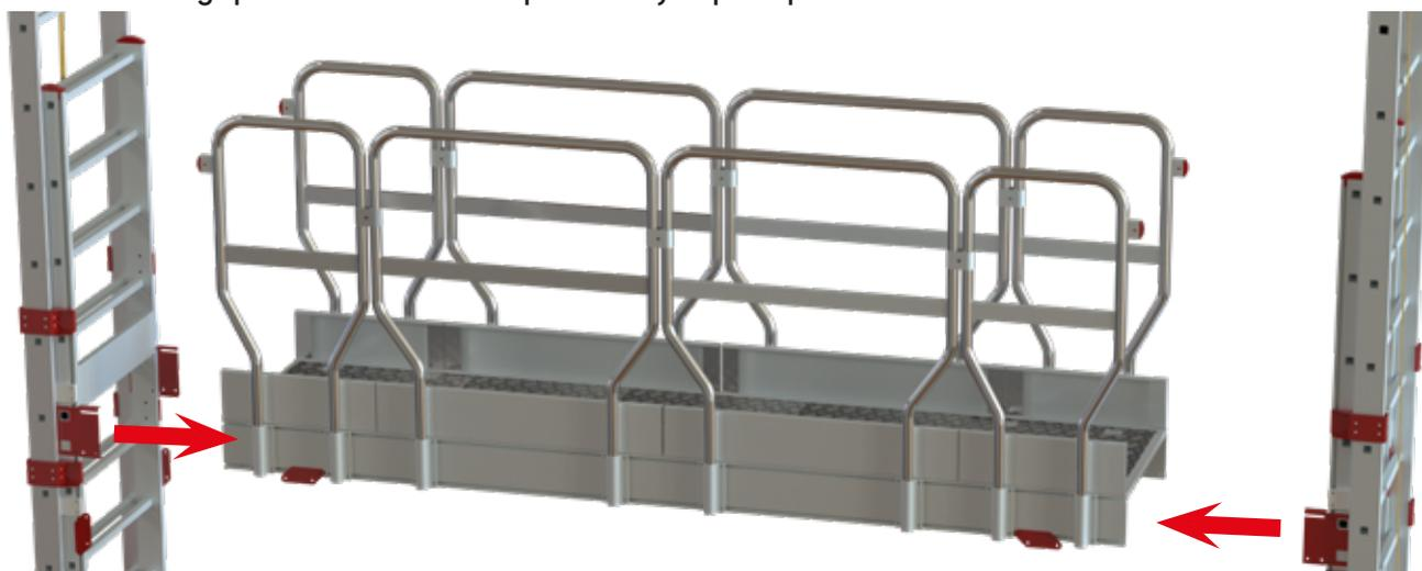
3. Fijarla colocando los 4 tornillos sobre la placa roja. 2 tornillos en los taladros inferiores y 2 tornillos en la apertura superior (separados entre sí lo máximo siempre que la arandela y tuerca aprieten sobre la placa roja. Repetir en las cuatro placas).
