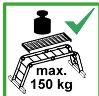
Carga máx. de la plataforma en posición de andamio declarado por el fabricante.
