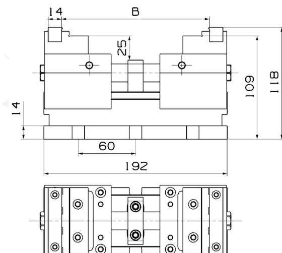
24/95 El carro tiene dos posiciones de anclaje al portabocas.
